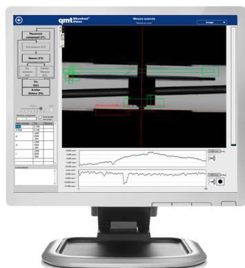
Le **qmtwheeltest-vision** permet la mise en rotation du composant avec une vitesse constante. Le système optique peut ainsi faire la mesure dynamique pour calculer les battements axiaux et radiaux ainsi que les éventuels partagements.
