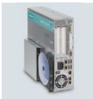
Le SIMATIC IPC627C se caractérise par sa compacité et ses performances élevées pour des tâches exigeantes de mesure, commande et régulation à des températures ambiantes jusqu'à 55 °C.
