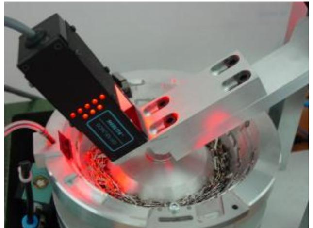
QMTSelect ist ein Produkt mit intelligenter Kamera und konfigurierbarer Vision Software. Die hohe Bildrate erlaubt eine automatische Detektierung der Teilepräsenz und damit die einfache Integration. Objektiv und Beleuchtung werden durch unsere Applikationsspezialisten definiert, damit die Funktionsweise für alle Teiletypen garantiert werden kann.
