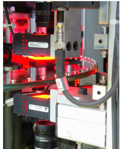
Double station verticale pour le contrôle d'aspect (QMTInspect-R)
