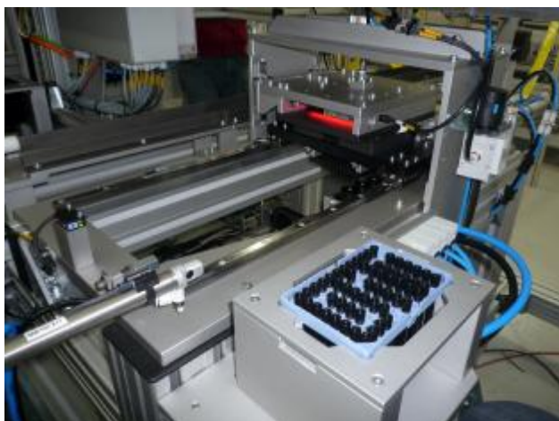
La station de contrôle motorisée QMTSort-PlastInject
